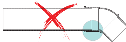
X KORREKTER Schnitt und FALSCH E Positionierung
